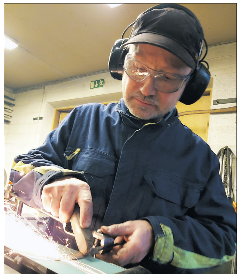
Martti Malinen teroittaa hiomakoneella puukonterää. Jos karkaisu ei onnistu, terästä ei saa terävää.
